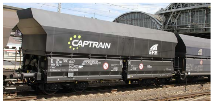
Captrain Falns 6643 met een l.o.b. 12,53 m, foto Anton Kendall
