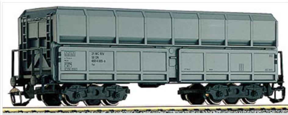
Afbeelding 1. Zelfflosser Fals 21 50 668 4009-9 van de Deutsche Reichsbahn door Tillig in samenwerking met de firma ZERBA.
