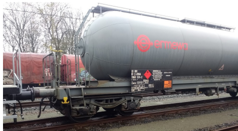
Afbeelding 7. Ermewa ketelwagen type Zacs met een l.o.b. van 16,20 m en een tankinhoud van ruim 73.000 l (foto Tonnie Kram)
