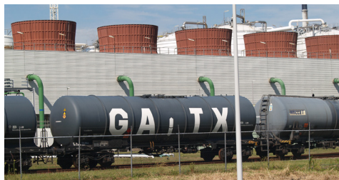
Afbeelding 10. Ketelwagen Zacns van GATX met een l.o.b. van 16,69 m, Europoort (foto Claudius Teijgeler)
