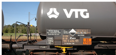
Afbeelding 19. VTB-ketelwagen met een l.o.b. van 14,40 meter (Foto internet)
