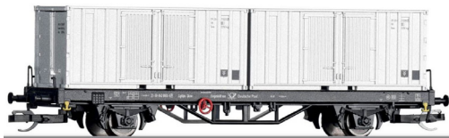
01109 bestaande uit twee containerwagens Lg-klips Deutschen Post beladen met twee 20'-containers tp IV,
